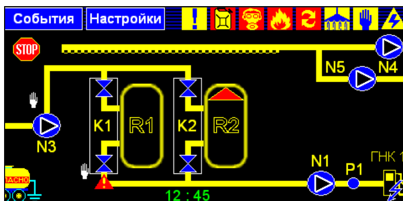
Рисунок 26 - Экран главной мнемосхемы (2 резервуара, 1 ГНК)
