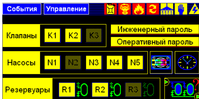
Рисунок 8 - Экран настроек оборудования шкафа
