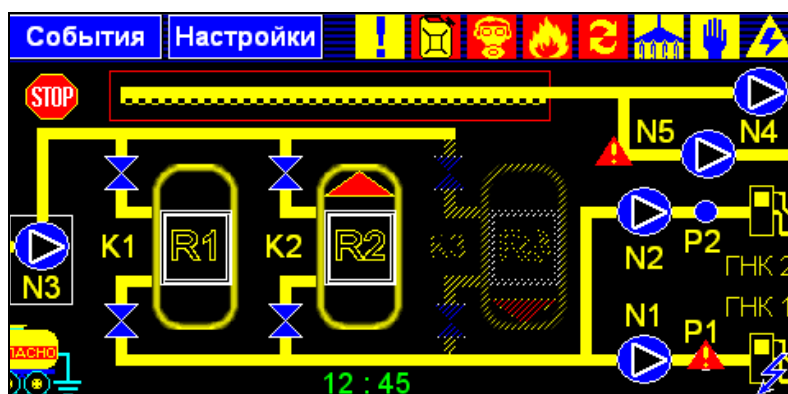
Рисунок 25 - Экран главной мнемосхемы (3 резервуара, 2 ГНК), резервуар R3 заблокирован
