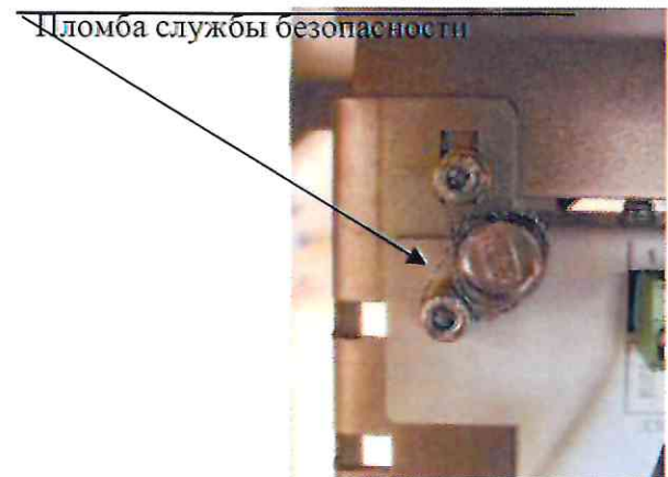
Рисунок 15 – Схема пломбировки узлов крепления БУ
