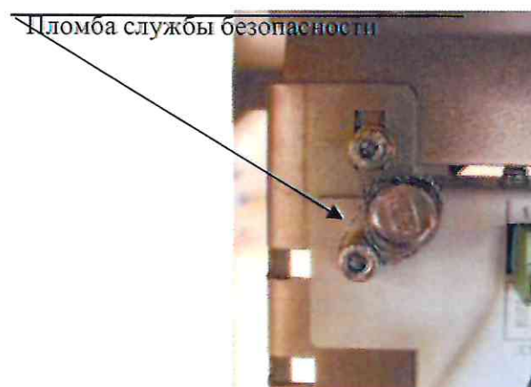
Рисунок 15 – Схема пломбировки узлов крепления БУ
