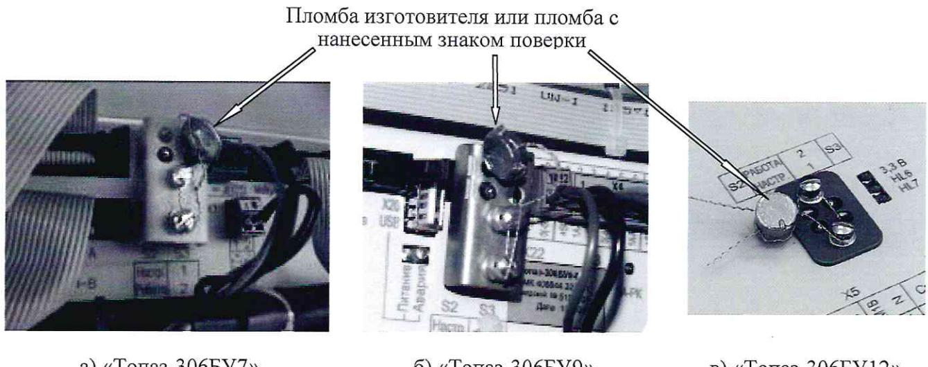
Рисунок 12 – Схемы пломбировки блоков управления
