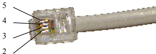
Нумерация контактов вилки 6Р4С (контакты 1 и 6 отсутствуют)
