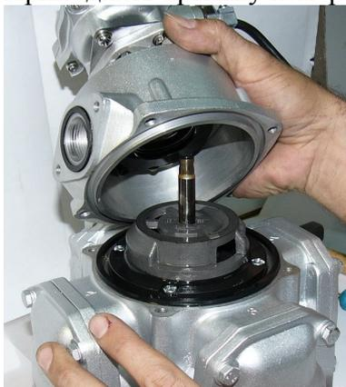
Внимание: Заметить положение клапана распределительного (золотника). При сборке измерителя он должен быть установлен в том же положении.
