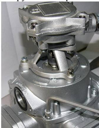
6. Приподнять крышку измерителя объёма.
