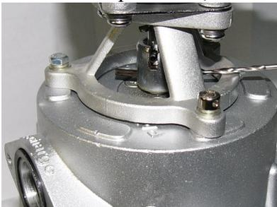
3. Слегка поддеть хвостовик плоской отверткой (сдернуть его).
