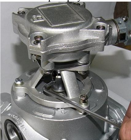
Выбить штифт стержнем или сверлом  $\varnothing 2,5\text{мм}$ .
