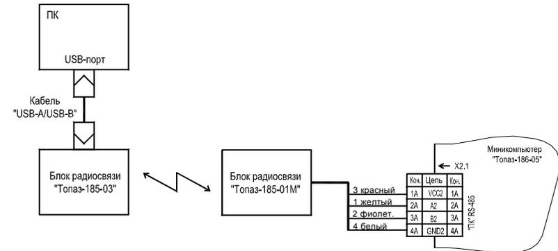
Рис. 3 Схема электрическая подключения мини-компьютера "Топаз-186-05" к ПК через блоки радиосвязи серии "Топаз-185".
