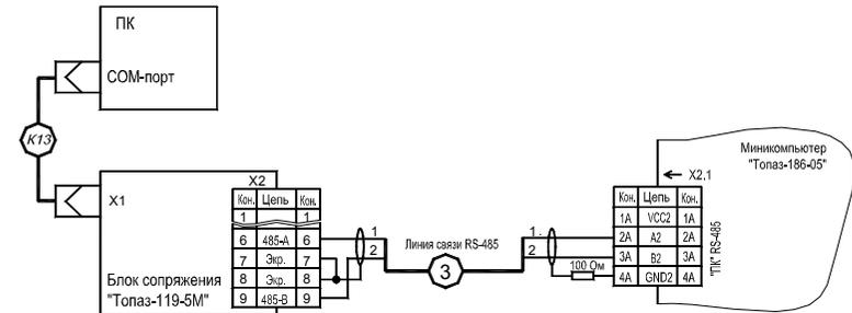
Рис. 2 Схема электрическая подключения мини-компьютера "Топаз-186-05" к ПК через блок сопряжения "Топаз-119-5М".
