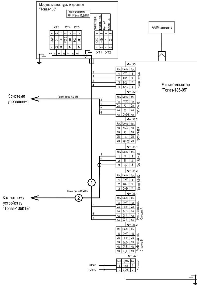
Рис. 1 Схема электрическая подключения мини-компьютера "Топаз-186-05".
