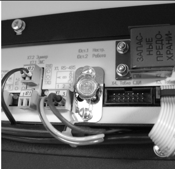
Рисунок В.2 Пломбировка блока управления
