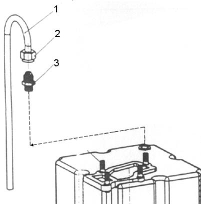
и подключения к поз.3 гибкого металлорукава внутренним диаметром, не превышающим 15 мм и его последующим подключением к резервуару забора топлива согласно приложенной схеме.
