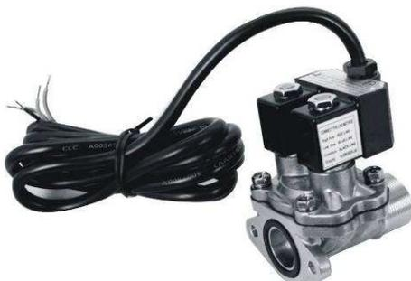
Клапан соленоидный предназначен для управления потоком топлива, обеспечивая снижение расхода топлива перед окончанием выдачи дозы и прекращение подачи топлива после выдачи заданной дозы. Соленоидный клапан имеет три состояния: закрыт, открыт на малый поток, открыт на большой поток. Управление состоянием клапана осуществляется путём подачи и снятия питающего напряжения.
