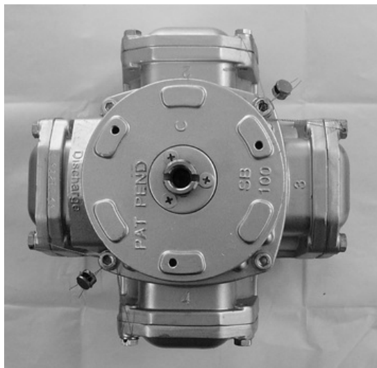
Рисунок В.1 Пломбировка генератора импульсов
